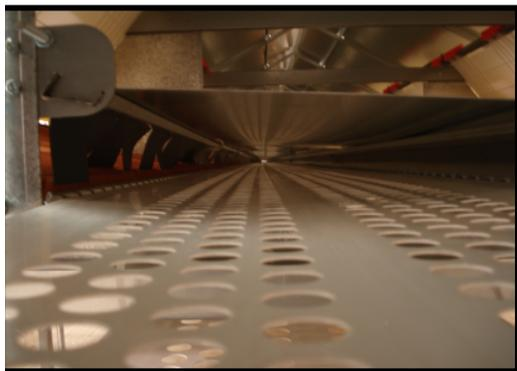
Durchlass für die Eier von der Nestmatte auf das Eierband ist ohne scharfe Kanten in einer sehr starken Ausführung gefertigt. So ist die Gefahr, dass sich die Tiere verletzen oder auf das Eierband gelangen, komplett ausgeschlossen.
